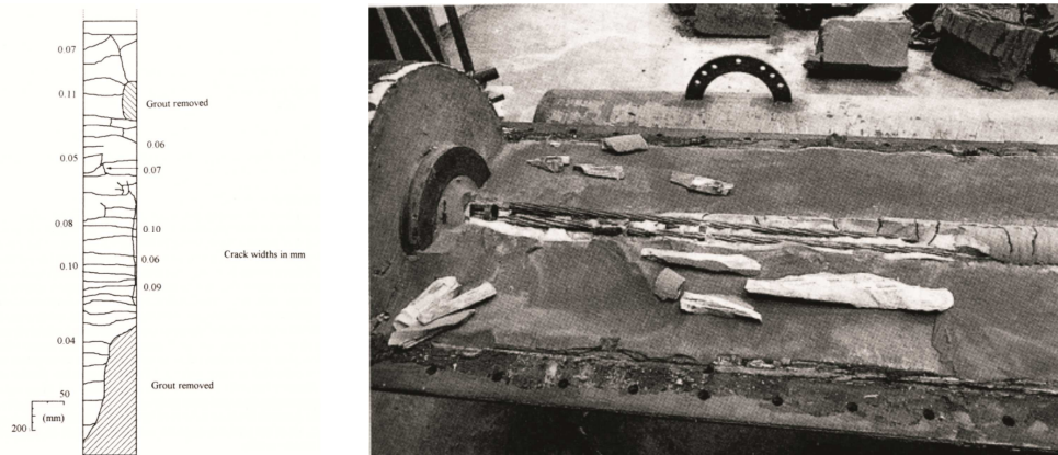
Obr. 1-13 Síť tahových trhlin kořene kotvy po modelové zatěžovací zkoušce (převzato z Weerasinghe, Littlejohn, 1997 )
